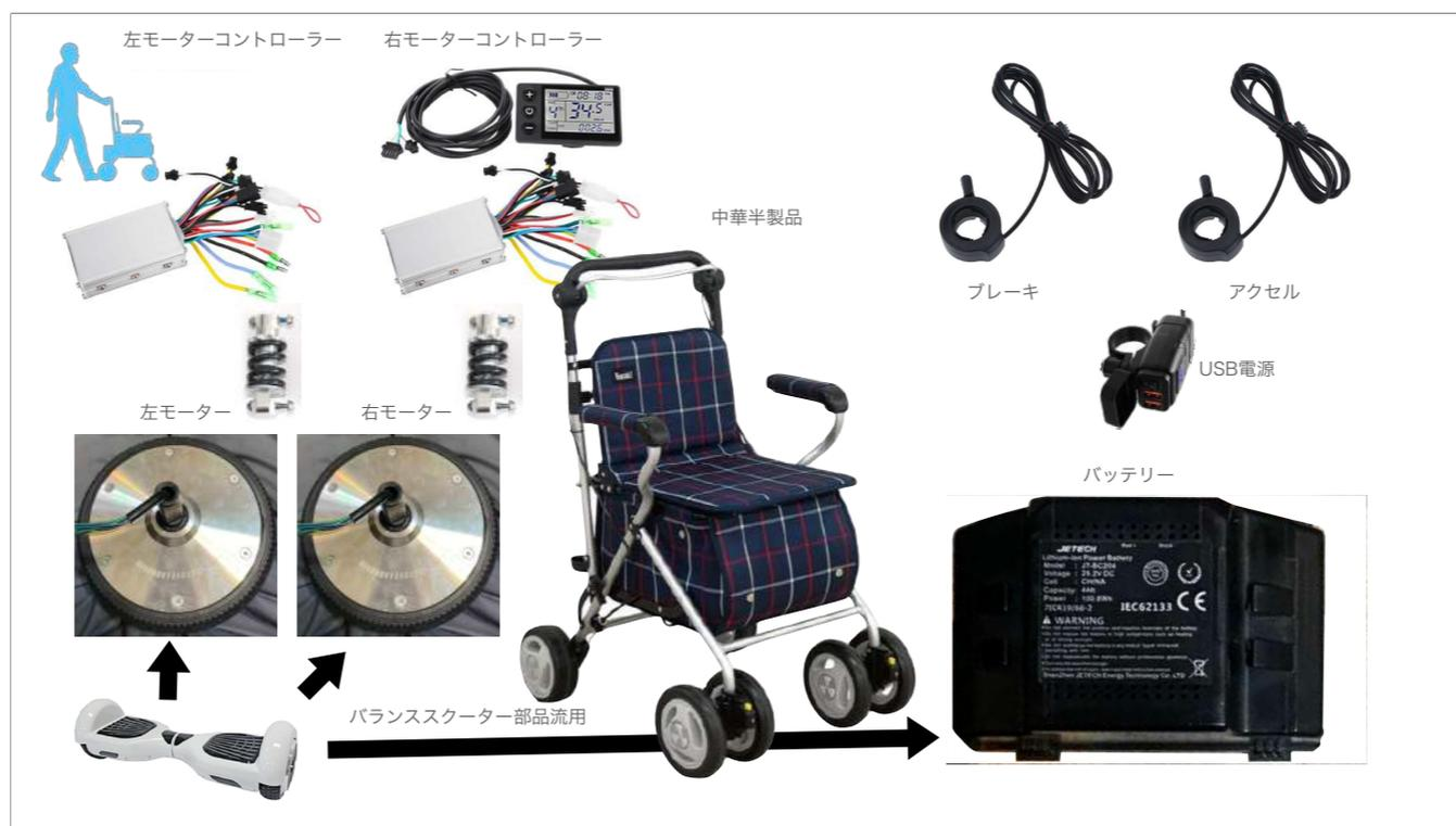
こちら、構成図になります。モーターとモーターコントローラー、サスペンションを2つずつに対してLCDディスプレイが一つ、ブレーキ、スロットルセンサー、バッテリーとUSBとなります。
